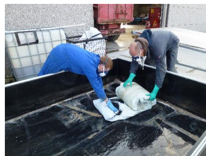
Vouw het zeil dicht op in de Heliosec® of Remdry® .
